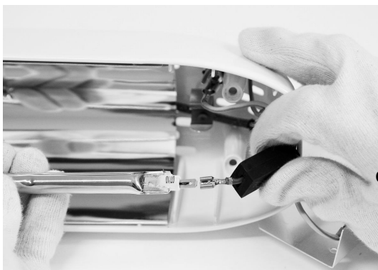
6. ПОДСОЕДИНИТЕ СОЕДИНИТЕЛЬНЫЙ РАЗЪЕМ ТИПА «ПАПА» ОТ НОВОЙ ЛАМПЫ К 2 ПРОВОДАМ. НАТЯНИТЕ НА НИХ СИЛИКОНОВЫЕ КАПСУЛЫ ВНОВЬ УСТАНОВИТЕ ЛАМПУ В ЕЕ ПРЕЖНЕЕ МЕСТОПОЛОЖЕНИЕ. ВНОВЬ СОБЕРИТЕ ОБОГРЕВАТЕЛЬ, СЛЕДУЯ ИНСТРУКЦИЯМ В ОБРАТНОМ ПОРЯДКЕ.
