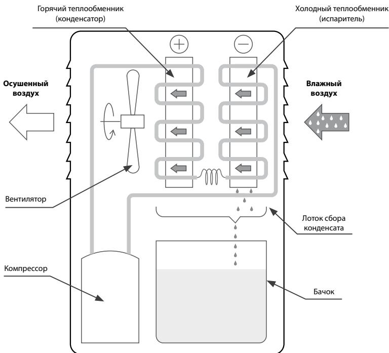
При работе с использованием внутреннего бака, при его наполнении конденсатом, осушитель отключается и на табло панели управления загорается индикатор заполнения бака «FULL». Для дальнейшей работы осушителя необходимо извлечь внутренний бак, освободить его от воды и установить назад в осушитель. Индикатор «FULL» при этом должен погаснуть.
