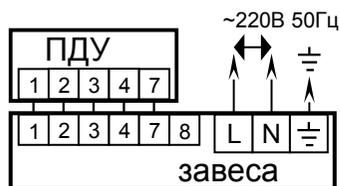
**Подключить сетевой кабель и ПДУ согласно маркировке рядом с клеммной колодкой.**
