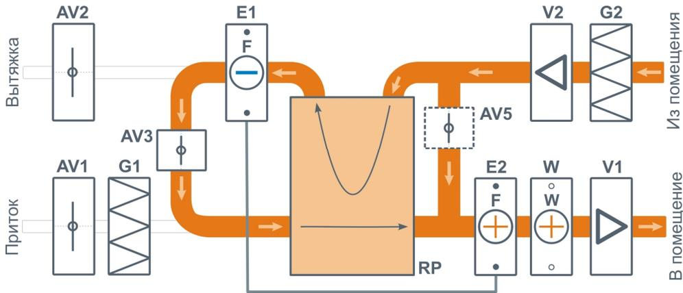
\* На схемах движения потоков не показан клапан AV4, поскольку он регулирует только тепловую производительность рекуператора. Также для упрощения на схемах не показаны датчики и другие элементы автоматики. Полная структурная схема вентиляционной установки приведена ниже.
