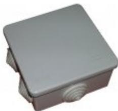
Модуль управления клапаном (соединительная коробка) СВ-02, 24В - 20мА. Позволяет управлять заслонкой клапана с помощью привода с пропорциональным управлением. Для управления модулем используется регулятор (потенциометр) JLC100. Напряжение питания DC 24V. Может транслировать от привода сигнал 0–10В, показывающий текущее положение заслонки.
