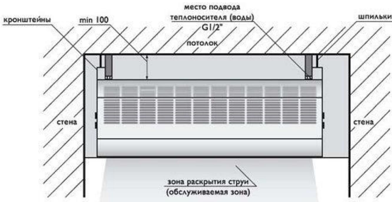
Установка аппарата не должна мешать циркуляции воздушного потока при его работе. При переустановке, в обязательном порядке отключается электропитание. Электрические розетки и провода под напряжением не должны находиться под занавесой.
