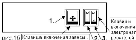
**5.2.2.** Нажатие на нижнюю часть любой из клавиш 2 и 3 включает половину мощности. Режим полной тепловой мощности включается нажатием на нижнюю часть обеих клавиш 2 и 3.
