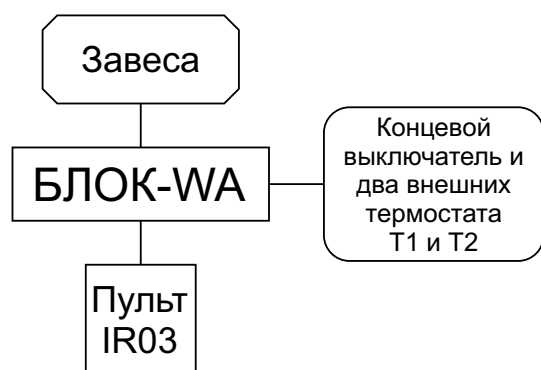
Рисунок 3. Структурная схема подключения одной завесы через БЛОК-WA
