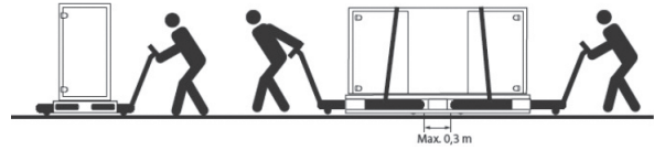
Рис. 1Б Подъем и перемещение вентустановок
