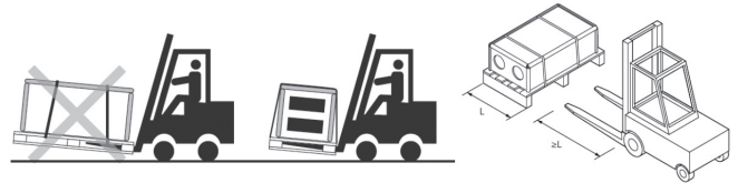
Рис. 1В Подъем и перемещение вентустановок
