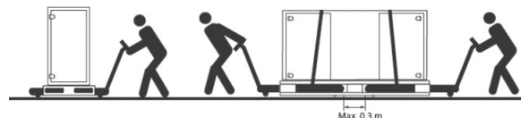
Рис. 1Б Подъем и перемещение вентустановок
