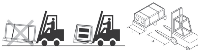
Рис. 1В Подъем и перемещение вентустановок
