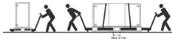
Рис. 1Б Подъем и перемещение вентустановок
