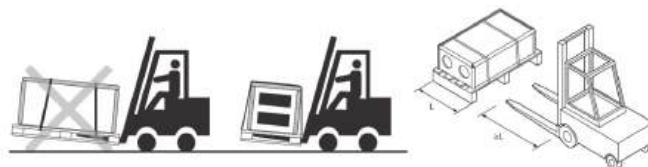
Рис. 1В Подъем и перемещение вентустановок
