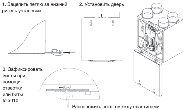
Рис. 4 Крепление двери на откидных петлях
