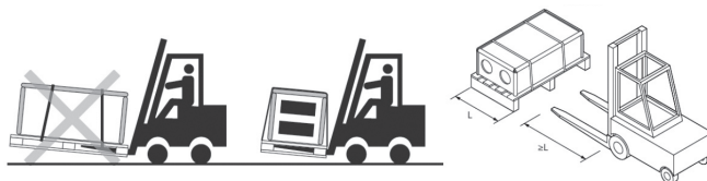
Рис. 1В Подъем и перемещение вентустановок
