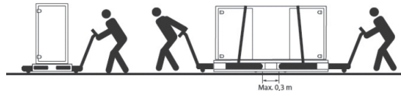
Рис. 1Б Подъем и перемещение вентустановок
