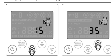
Кнопка «вентилятор» переключит режим смены группы на режим выбора параметра. Режим выбора номера параметра Режим выбора номера параметра
