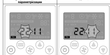
Стрелками «вверх» или «вниз» устанавливаются часы. Переход к редактированию минут — нажать кнопку «вентилятор». Стрелками «вверх» или «вниз» устанавливаются минуты. Переход к редактированию даты — нажать кнопку «вентилятор».
