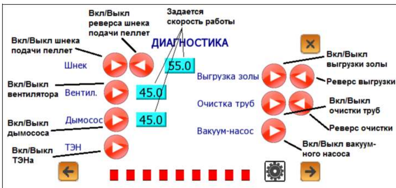
Рис. 25. Включение отдельных агрегатов котла
