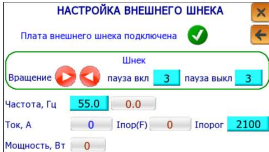
Рис. 12. Настройки шнека подачи пеллет из внешнего хранилища.
