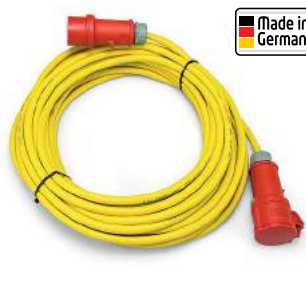
Удлинительный кабель 400 В, 16 А, H07RN-F 5G2,5
