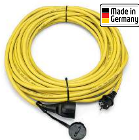
Удлинительный кабель 230 В, 16 А, H07RN-F 3G2,5
