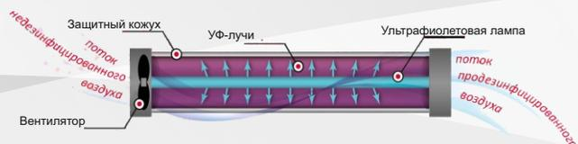
Рециркуляторы являются облучателями закрытого типа, в которых бактерицидный поток от ультрафиолетовой лампы распределяется в небольшом замкнутом пространстве.
