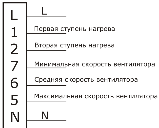
Рис. 4. Электрическая схема подключения пульта управления
