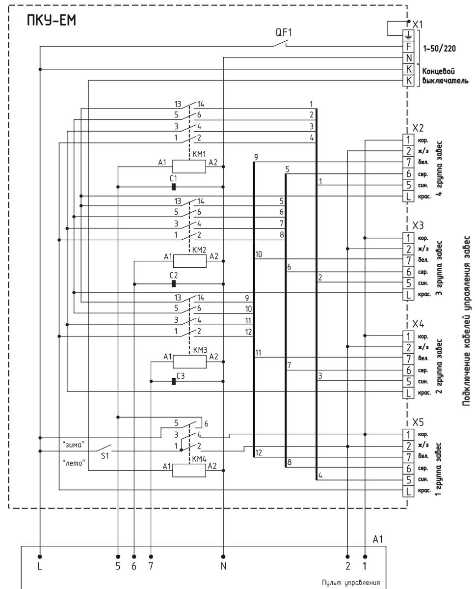
Подключение кабелей управления зазем
