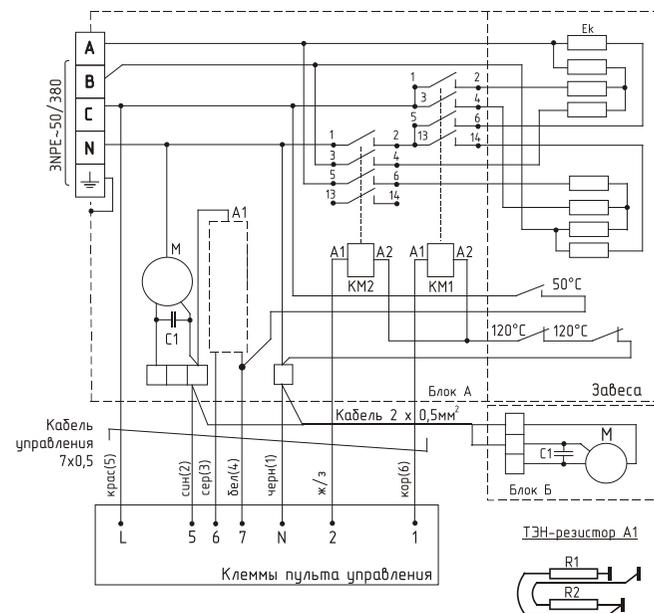
Рис. 2. Электрическая схема КЭВ-12П303Е
