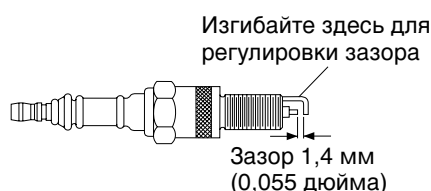
Рис. 12. Регулировка зазора свечи зажигания, нагреватель мощностью 10 кВт
