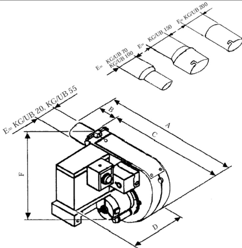
Brennerflansch / Burner flange /
