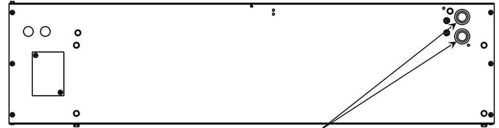
подвод и отвод воды внутренняя резьба DN20 ( 3/4" )
