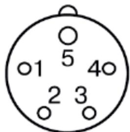
Рис. 2 Схема контактов на вилке
