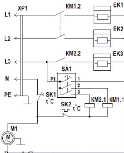
Схема коммутации переключателя SA1
