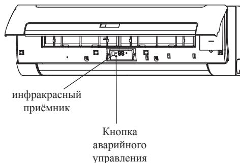
При нажатии кнопки аварийного управления устройство будет включаться в следующих режимах:
