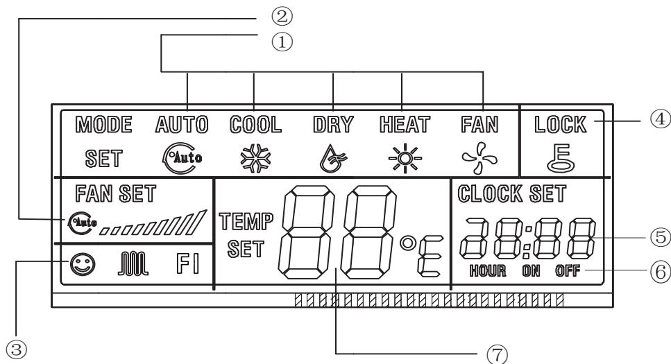
1. Поле дисплея отображающее выбранный режим работы устройства. Изменение режима работы устройства осуществляется с помощью нажатия кнопки [MODE] (режим HEATING не активен для устройств предназначенных только для охлаждения).
