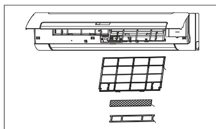
2. Смывайте грязь с сетки фильтра с помощью мягкого моющего средства, тряпочки и воды до тех пор, пока вы не увидите ни одной пылинки
