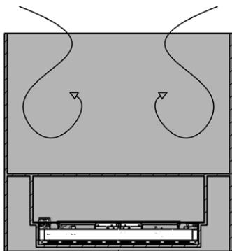
Устанавливайте биокамин Denver e-Ribbon Fire в открытую конструкцию стены, которая закрыта над камином и не создает воздушный поток вокруг самого камина.
