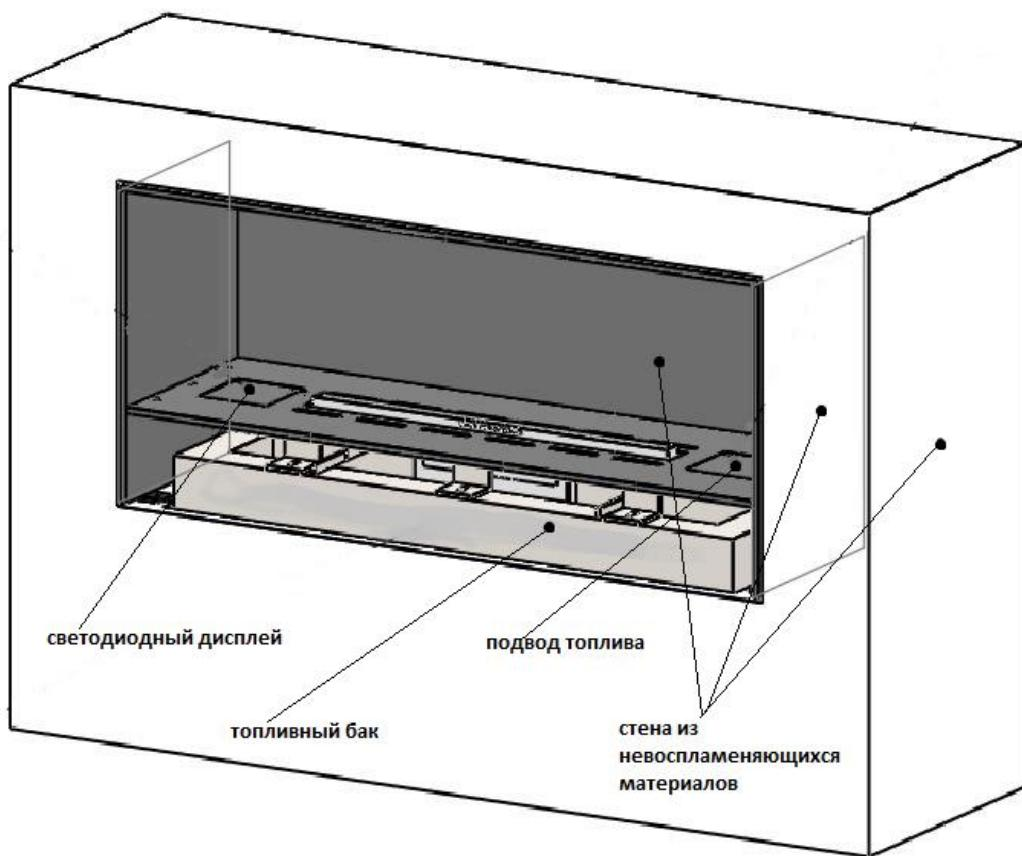
Опорные стойки слева и справа внутри ниши, на которые будет опираться камин, должны быть изготовлены из прочного невоспламеняющегося материала, например, металла, бетона или кирпича. Опоры должны быть выставлены идеально по уровню – горизонтально и вертикально.
