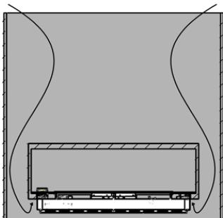
**НЕ** встраивайте биокамин Denver e-Ribbon Fire в конструкции стены которая открыта над камином и под камином. Теплый воздух явится причиной воздушного потока внутри пустой конструкции, что негативно скажется на пламени, оно не будет гореть равномерно.
