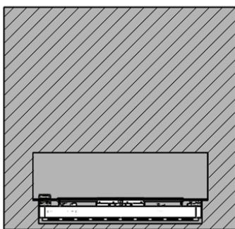
Встраивайте биокамин Denver e-Ribbon Fire только в стену из негорючих материалов: кирпича, камня, газобетонных блоков. Используйте те размеры, которые указаны выше в инструкции и в вашем индивидуальном проекте.
