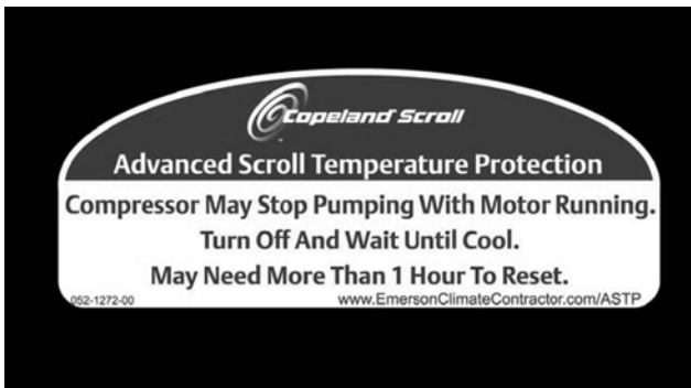
Рис. 17 – Этикетка, указывающая на наличие усовершенствованной тепловой защиты спирали
