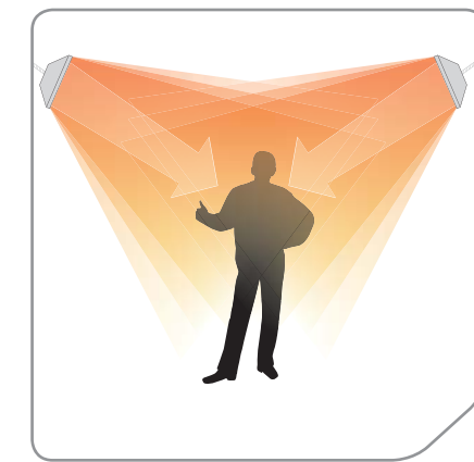
Возможна установка под углом, позволяющая повысить эффективность обогрева
